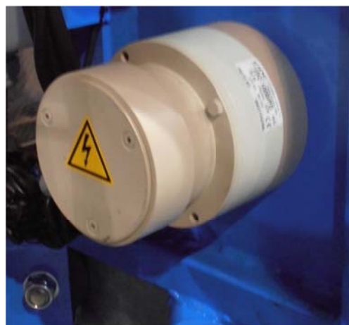
FREIN PARACHUTE, AVEC AUTO-RÉTABLISSEMENT
